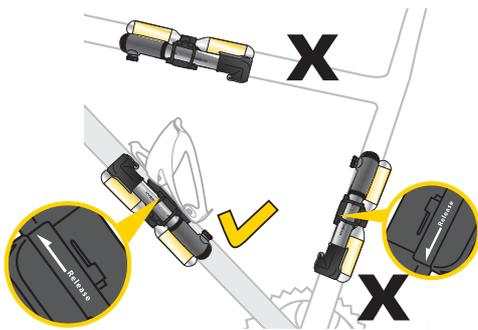
Assicuratevi di installare la serie pompe HybridRocket e le cartucce di CO<sub>2</sub> sul lato che non si guida (sinistra) ovvero solo sul tubo obliquo. La freccia per il rilascio deve seguire il tubo obliquo. NON installare la serie pompe HybridRocket sul tubo reggisella o tubo orizzontale.
